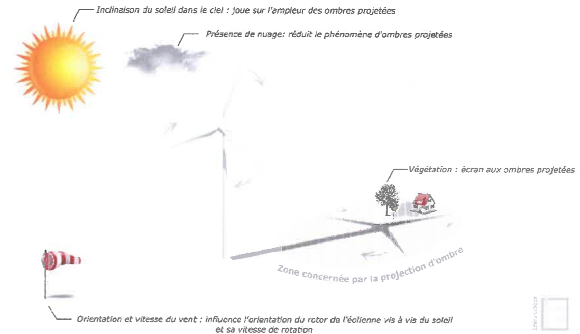
Figure 278 : Schématisation du phénomène d'ombre projetée
